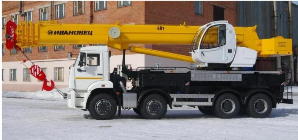
**Рисунок Б.1 – Автомобильный крана КС-65740-8**
