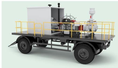
**Рисунок И.1 – Промывочно-опрессовочный агрегат**
