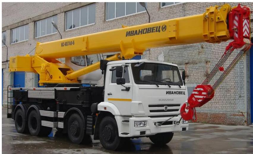
*Рисунок Б.1 – Автомобильный крана КС-65740-6*
