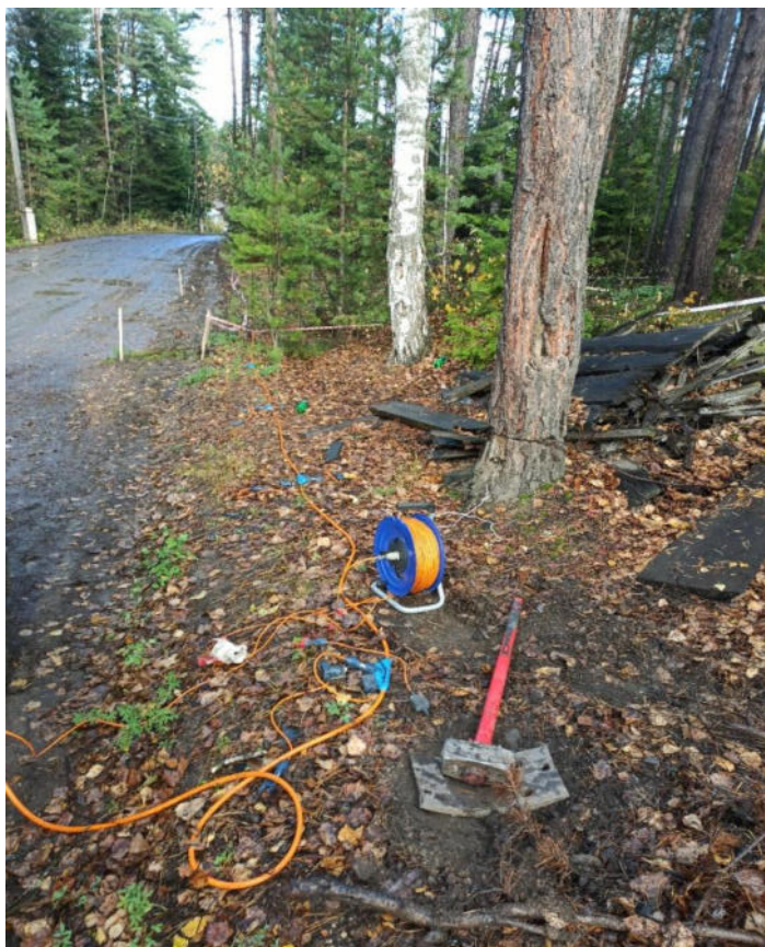
Частотный диапазон регистрируемых сейсмических сигналов от 5 до 500 Гц. Для возбуждения сейсмических волн использовалось ударное устройство (кувалда) весом 8 кг. Продольные волны Р возбуждаются вертикально, а поперечные S – горизонтально направленными ударами. Длина сейсмокося 46 метров (рисунок 5.3.1). С шагом между приемниками – 2 метра. Система наблюдений встречные годографы. Регистрация сейсмических колебаний осуществлялась вертикальными сейсмоприемниками DLX-10
