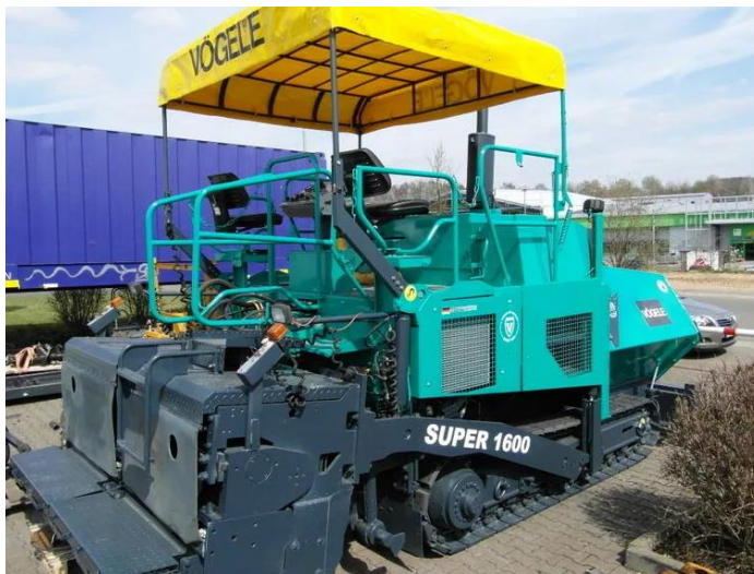
Рисунок Р.1 – Асфальтоукладчик VogeLe super 1600
