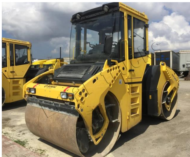
Рисунок Н.1 – Дорожный каток Bomag BW 161 AD-4
